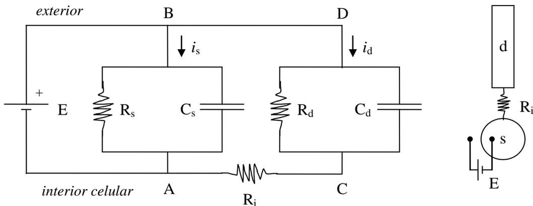
**Datos:**  $C_s = 5$  nF ;  $C_d = 1$  nF ;  $R_s = 1$  G $\Omega$  ;  $R_d = 12$  G $\Omega$  ;  $R_i = 1$  G $\Omega$  ;  $E = 100$  mV (negativo en el interior). (n:  $10^{-9}$  ; G:  $10^6$  ; m:  $10^{-3}$ )
